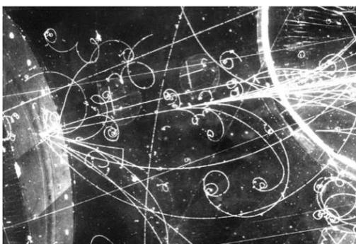
Il s'agit d'une enceinte remplie d'un liquide à une température légèrement supérieure à celle de vaporisation. Le passage d'une particule chargée déclenche la vaporisation et les petites bulles formées matérialisent la trajectoire de la particule. D'autre part l'ensemble est plongé dans un champ magnétique uniforme et stationnaire, qui courbe les trajectoires et permet ainsi d'identifier les particules (à partir de leur masse et de leur charge).
