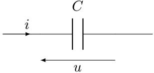
La relation courant-tension d'un condensateur est, en convention récepteur
