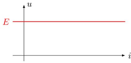
Un générateur de tension délivre la même tension  $E$  quel que soit le courant  $i$  le traversant.
