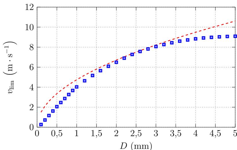
FIGURE 1 – Influence du diamètre des gouttes sur la vitesse limite.
