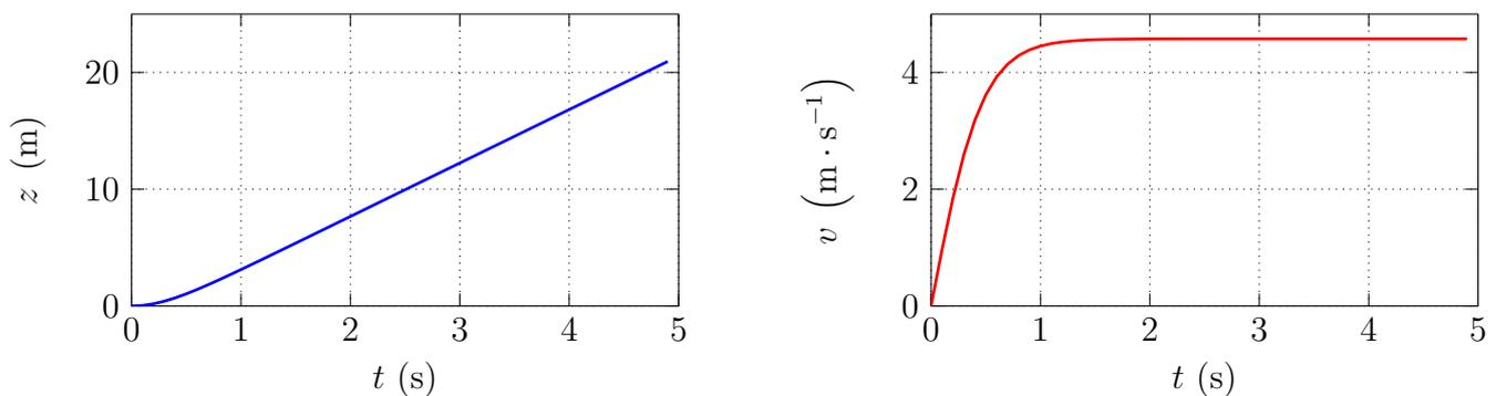
FIGURE 2 – Position  $z(t)$  et vitesse  $v(t)$  au cours de la chute d'une goutte de 1 mm de diamètre, courbes obtenues en traçant les résultats de l'algorithme d'Euler ci-dessus.
