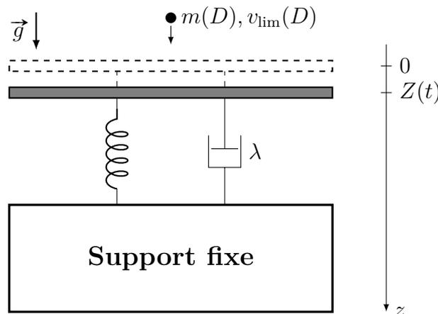
FIGURE 4 – Modélisation du disdromètre à impact à platine.
