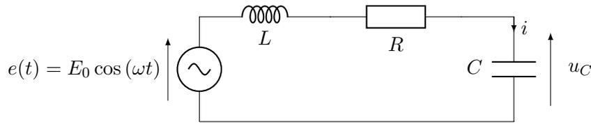
On refait le circuit en remplaçant les composants passifs ( $R$ ,  $L$  et  $C$ ) par leurs impédances et les tensions par leurs amplitudes complexes :
