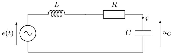
On choisit  $L = 102$  mH et  $C = 212$  nF. Ainsi, la fréquence propre est :
