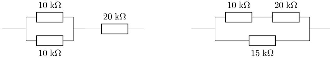
Dans le premier circuit, on détermine déjà la résistance équivalente aux deux résistances en parallèle :
